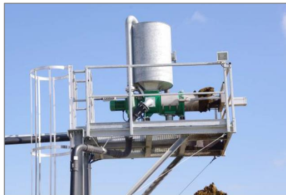
Photographie 19 : Exemple de séparateur de phases sur plateforme (Source : agriKomp)
