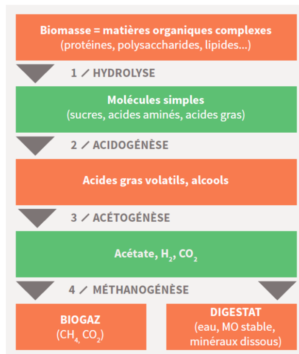
Figure 9 : Réactions biologiques mises en œuvre au cours de la digestion anaérobie
