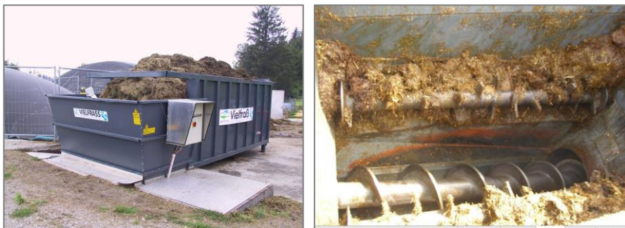
Figure 17 : Technologie d'incorporation des matières solides
