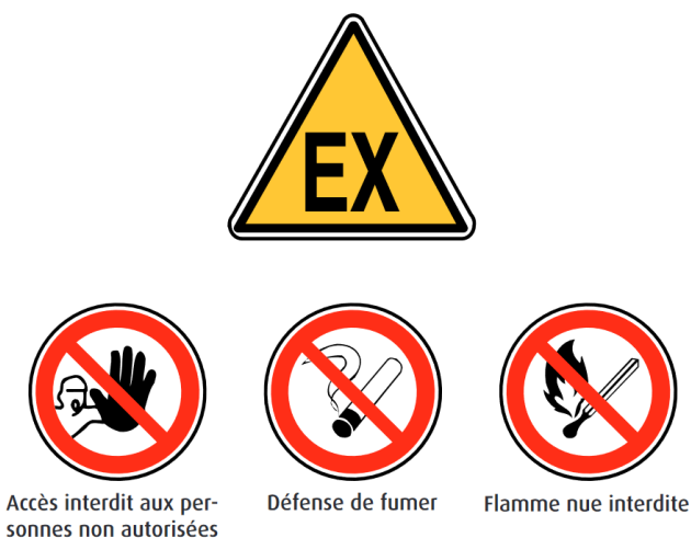
Figure 32 : Signalisation des zones ATEX et affichage de sécurité (Source : INERIS)
