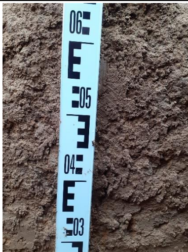
Vue de la partie médiane de la coupe (horizon rédoxique n s'intensifiant pas en profondeur)
