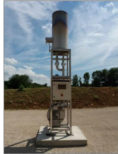
Photographie 25 : Torchère biogaz (Source : agriKomp)
