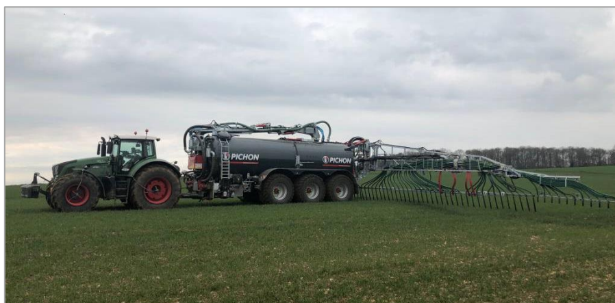
Photographie 26 : Épandage avec tonne à lisier avec pendillards
